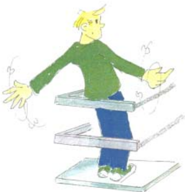
Platform med rækværk og knæliste
